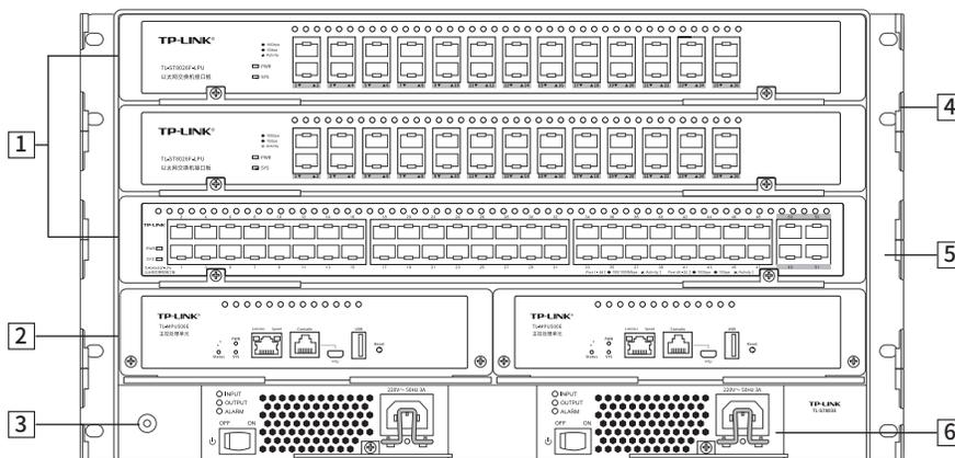
图1-3 TL-S7803E机框结构示意图 (正面)
