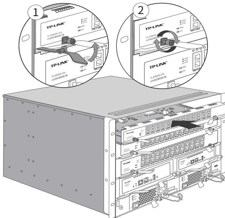
图4-2 带L型手柄单板安装示意图
