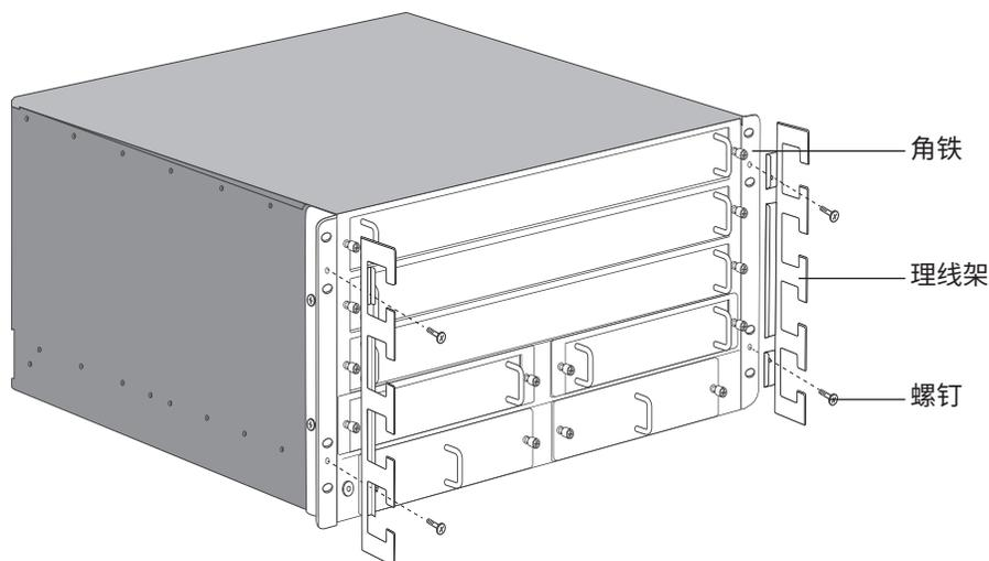
图2-1 理线架和角铁安装示意图
