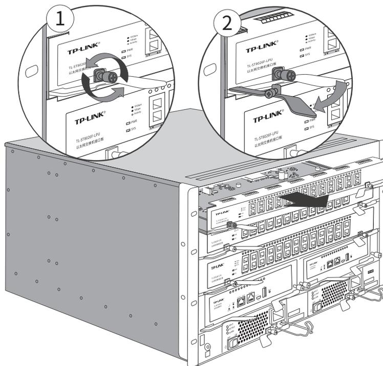
图4-1 带L型手柄单板拆卸示意图
